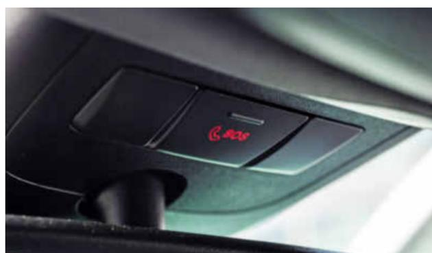
Hilfe auf Knopfdruck: Die Notruftaste für den E-Call findet sich entweder am Dachhimmel oder in der Mittelkonsole. Foto: dpa
