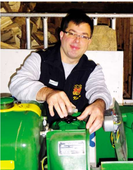
Vor dem Anlassen muss Karsten Rodewald die Ventile des Deutz D 15 von Hand anölen.
