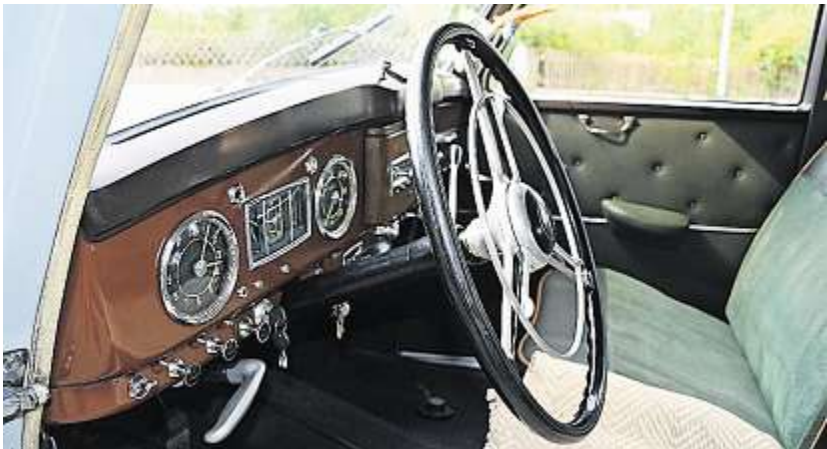
Ein Blick auf Armaturenbrett und Lenkrad. Der innere Chrom-Ring am Lenkrad hat zwei Funktionen: Drückt man den Ring ertönt die Hupe. Dreht man bis zum Einrasten nach links oder rechts daran, schaltet sich der Blinker ein.
