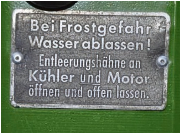
Dieses Hinweisschild war einst übersehen worden, das Wasser wurde die Eis, der Kühler platzte.
