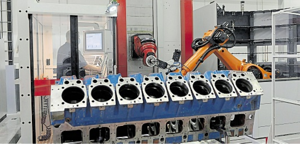
Thomas Meiners bedient den robotergestützten Werkzeugwechsler. Dank eines fünffachen Systems kann der Schwenkkopf Werkstücke auf fünf Seiten bearbeiten. Foto: Thomas Pertz
