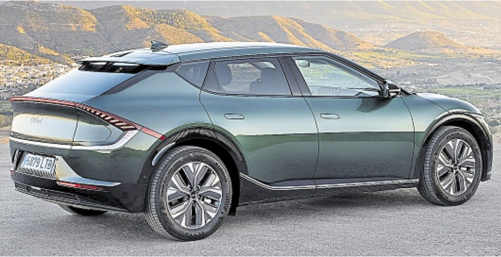
Kia bietet den EV6 mit zwei Batteriegrößen an, 58 und 77,4 kWh, die Reichweite nach WLTP soll bis zu 528 Kilometer betragen.
