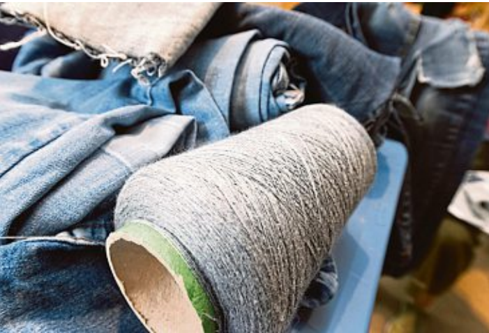
Der Stoff wird geschreddert, bis ein flauschiges Gewebe ähnlich der Baumwollpflanze herauskommt. Daraus entsteht neues Garn.
