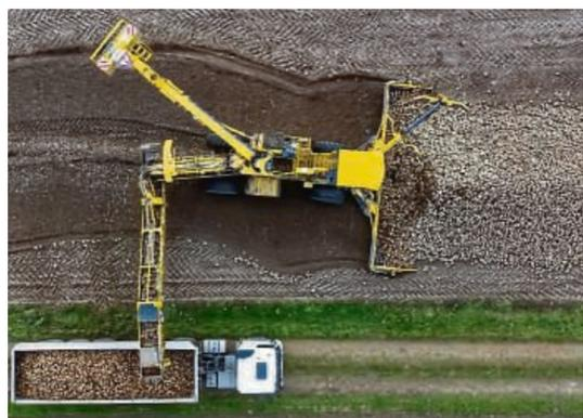
Mit einer sogenannten Rübenerntemaschine werden Zuckerrüben auf einen Lastwagen verladen. FOTO: DPA
