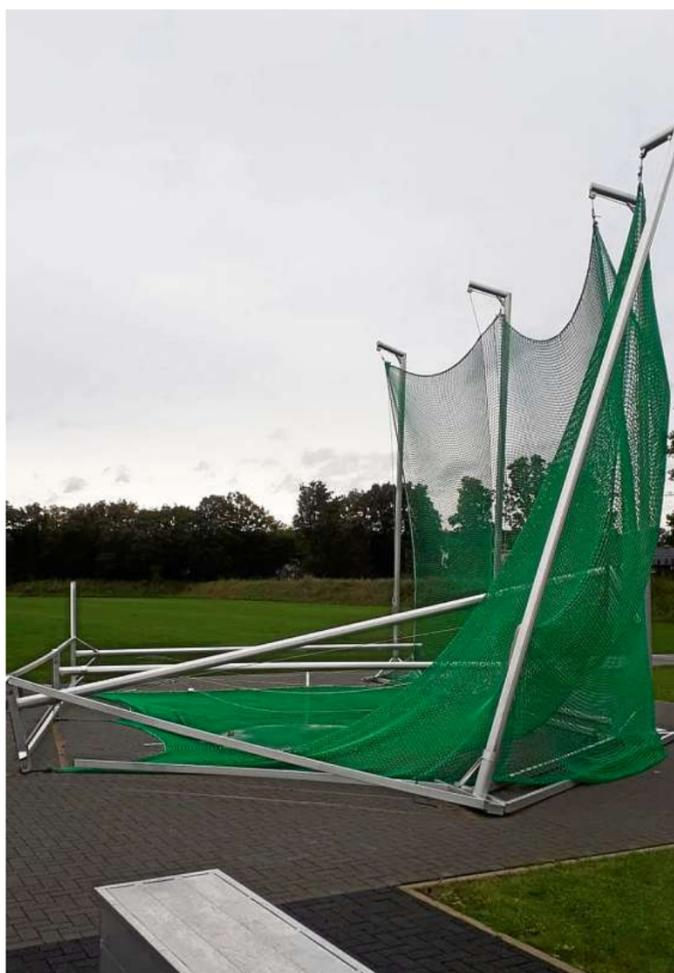
Der Wurfkäfig beim SuS 09 ist im Wind zusammengebrochen. Mittlerweile wurde die Anlage zur Sicherheit ganz abgebaut.
