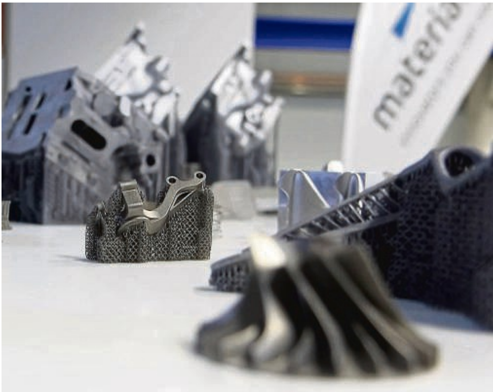
Ein Drucker, zahlreiche Möglichkeiten: Richtig programmiert, stellen die 3D-Maschinen Bremspedale, aber auch Einspritzpumpen und Pumpenräder her. FOTO: KOLLER
