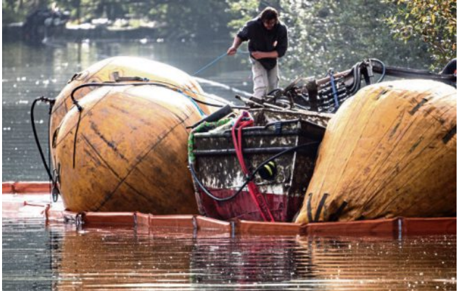
Mit Hebesäcken wird das gesunkene Fahrgastschiff „Moornixe“ an die Wasseroberfläche gehoben. Das Schiff war beim Ruhrhochwasser im Juli von einem Baum gerammt und mitgerissen worden. FOTO DPA
